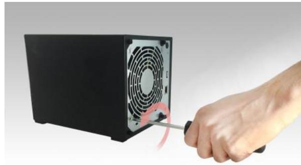
4. Positionieren Sie die Halterung über dem Loch für die entfernte Lüfterschraube. Befestigen Sie die Halterung, indem Sie die Lüfterschraube ersetzen.
