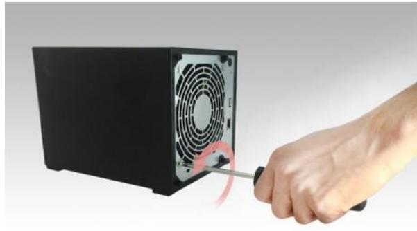
4. Positionnez le support sur le trou pour la vis enlevée du ventilateur. Fixez le support en remplaçant la vis du ventilateur.
