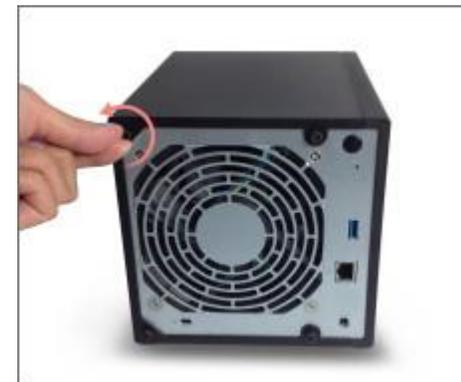
2. Posizionare la device su una superficie piana. Da notare le diciture che indicano la direzione di apertura e chiusura della cover. Rimuovere la cover facendola scorrere nella direzione mostrata dalle frecce presenti nelle foto sottostanti.
