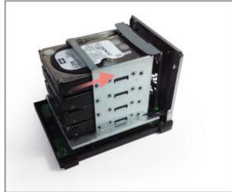
**Nota: inserire il disco rigido nell'alloggiamento HDD 1 mostrato nell'immagine per poterlo inizializzare.**
