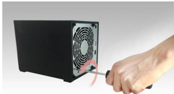
4. Расположите кронштейн напротив отверстия вывернутого винта вентилятора. Зафиксируйте кронштейн винтом на месте, таким образом заменив винт вентилятора.
