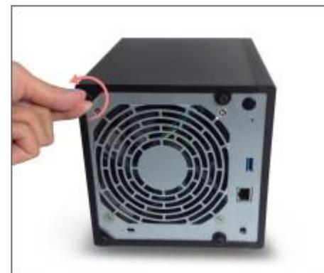
2. Положите устройство боком на плоскую горизонтальную поверхность. Снимите крышку, сдвинув ее в сторону, как показано ниже.
