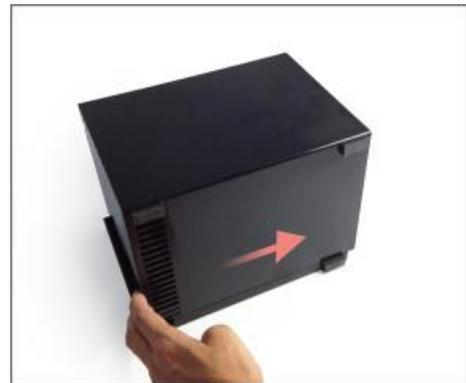
3. Установка 3.5-дюймовых жестких дисков: Вставьте HDD в отсек для жестких дисков до упора, как показано ниже. Каждый накопитель должен соединиться с соответствующим ему SATA-разъемом.
