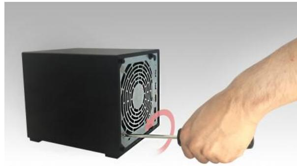
4. Sitúa el soporte sobre el agujero del tornillo que has quitado. Fija el soporte volviendo a poner el tornillo del ventilador.
