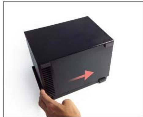
3. Instale el disco/s de 3.5": Deslice el disco en el hueco hasta comprobar que conecta correctamente con el conector SATA de la unidad firmemente.
