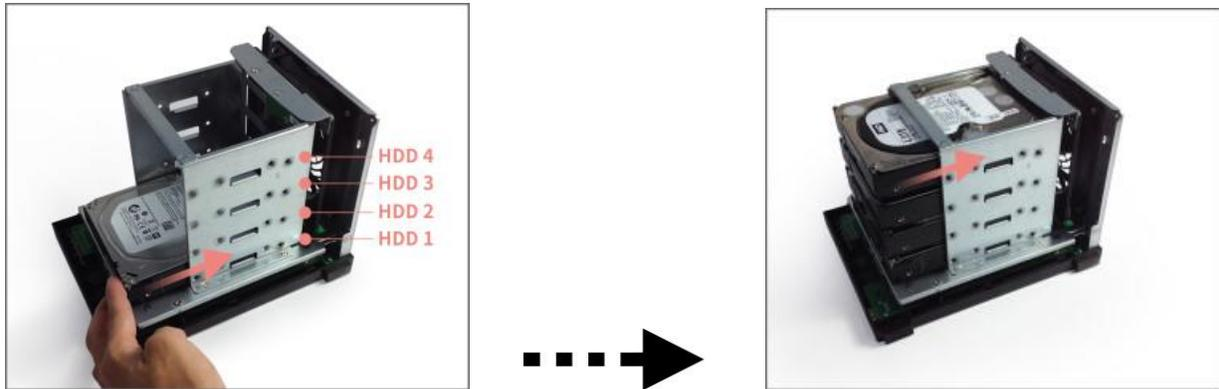
4. Asegure los discos con los tornillos adjuntos como muestra el gráfico.
