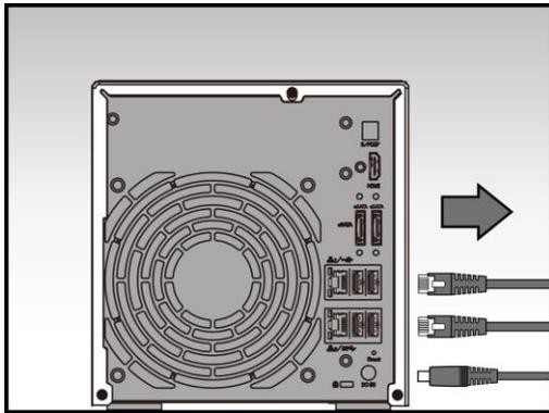
3. Utilice un destornillador para aflojar los tres tornillos situados en la parte posterior del NAS, tal como se muestra en la imagen.
