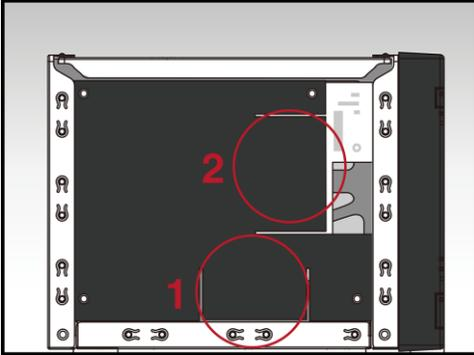
2. Para quitar los módulos de memoria, tire hacia atrás la cubierta protectora negro, y luego soltar los clips de expulsión tirando suavemente hacia los lados. Retire los módulos de memoria.
