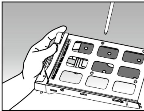
4. Deslice la unidad de disco en los raíles de la bahía de disco. Con la ayuda del mecanismo de seguro, empuje suavemente la bandeja de disco hasta que quede encajada en la bahía de disco. Presione el mecanismo de seguro para fijar la bandeja de disco. El mecanismo de seguro se cerrará fácilmente mediante un clic. Compruebe que la bandeja de disco esté correctamente introducida en la bahía de disco antes de cerrar el mecanismo de seguro.
