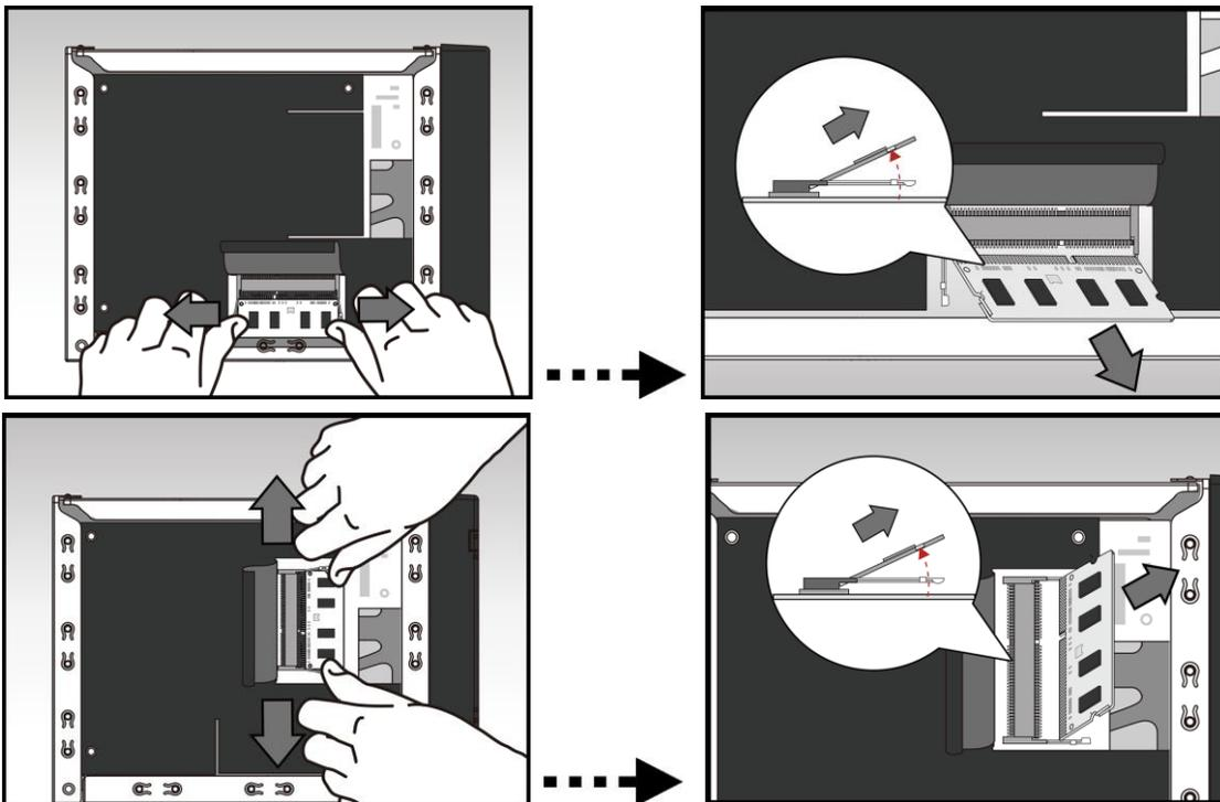
3. Deslice diagonalmente el nuevo módulo de memoria en la ranura número 1 (como se muestra en el gráfico de abajo) asegurándose de que los conectores del módulo de memoria están completamente insertados en la ranura. Usando dos dedos, empuje con cuidado hacia abajo hasta que el módulo de memoria encaje en su lugar. Usted debe oír un "clic" cuando esté correctamente colocado.
