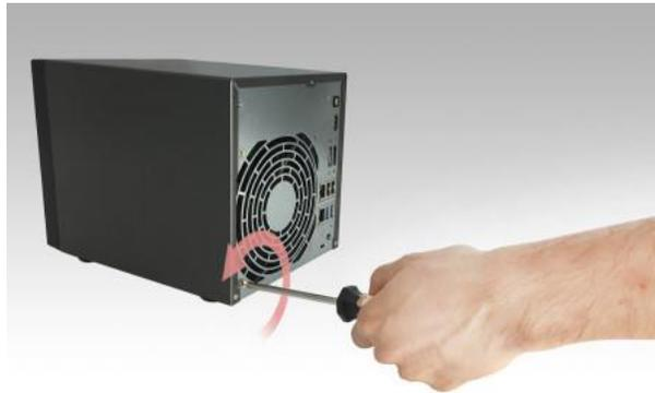
4. Sitúa el soporte sobre el agujero del tornillo que has quitado. Fija el soporte volviendo a poner el tornillo del ventilador.
