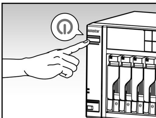
4. El NAS estará listo para usarse una vez que el indicador LED verde de estado del sistema deje de parpadear y se estabilice. El zumbador del sistema también emitirá una señal sonora. La instalación de hardware ha finalizado. Consulte la guía de instalación de software para configurar los ajustes del sistema.
