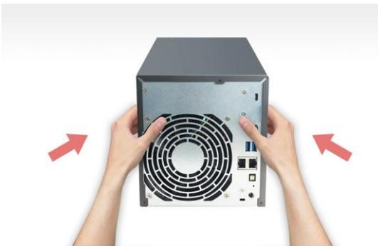
2. 接上 NAS 的电源线和其他所有接线，然后启动 NAS。
