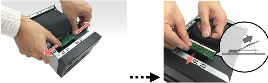
3. 安装至系统预载的卡扣上，斜放内存，并将内存金属接点完全推入插槽。两只手指平均施力，压下内存模块，当内存进入正确位置后，会发出一声“喀答”。
