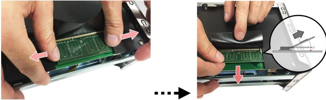
3. 安装至卡扣上，斜放内存，并将内存金属接点完全推入插槽。两只手指平均施力，压下内存模块，当内存进入正确位置后，会发出一声“咯答”。
