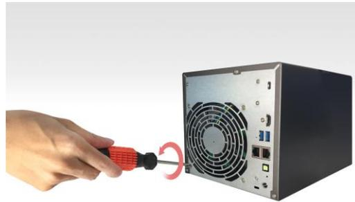
4. 将扣环锁到风扇螺丝孔的位置，依箭头方向锁紧。
