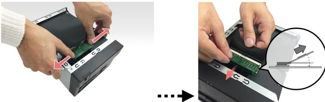
3. Schieben Sie in Slot Nr. 1 das neue Speichermodul diagonal ein (wie in der folgenden Grafik dargestellt) und sorgen Sie dafür, dass der Steckverbinder des Moduls vollständig in den Steckplatz eingesetzt wird. Drücken Sie nun mit zwei Fingern vorsichtig auf die Kante des Speichermoduls und schwenken dann das Speichermodul nach unten bis es einrastet. Es sollte ein "Klick"-Geräusch zu hören sein.
