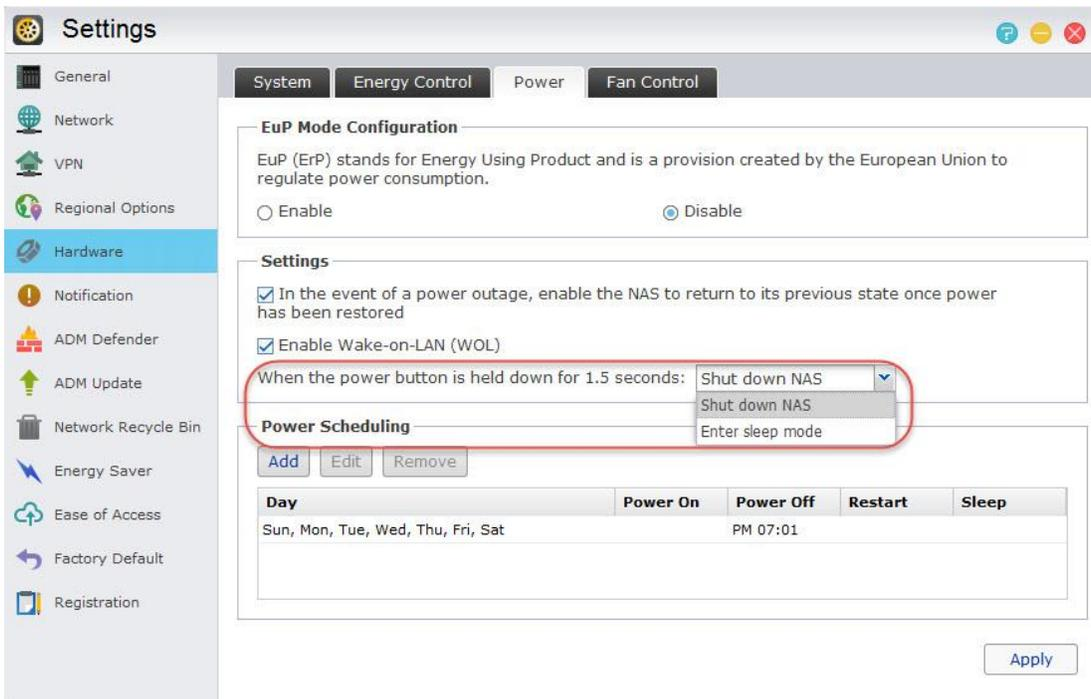
2. Halten Sie den Power Button 1,5 Sekunden lang gedrückt. Aus dem Systemlautsprecher sollte ein Piepton hörbar sein. Lassen Sie den Power Button los. Abhängig von der vorgenommenen Einstellung wird das NAS jetzt heruntergefahren oder in den Ruhezustand versetzt.
