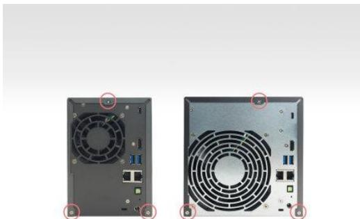
4. Greifen Sie die Abdeckung von beiden Seiten mit beiden Händen, schieben Sie sie dann zum Entfernen vom Gehäuse vorsichtig nach hinten.
