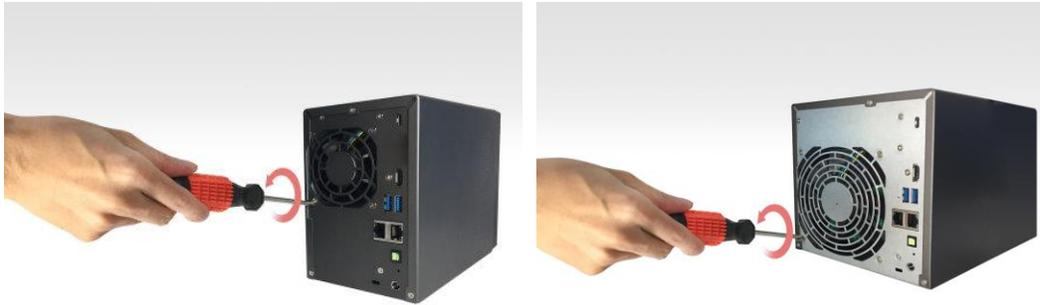
4. Positionieren Sie die Halterung über dem Loch für die entfernte Lüfterschraube. Befestigen Sie die Halterung, indem Sie die Lüfterschraube ersetzen.
