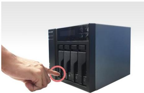
2. Ziehen Sie die Laufwerkhalterung am Riegel sanft aus dem Laufwerkschacht.
