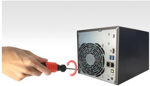
4. Sitúa el soporte sobre el agujero del tornillo que has quitado. Fija el soporte volviendo a poner el tornillo del ventilador.
