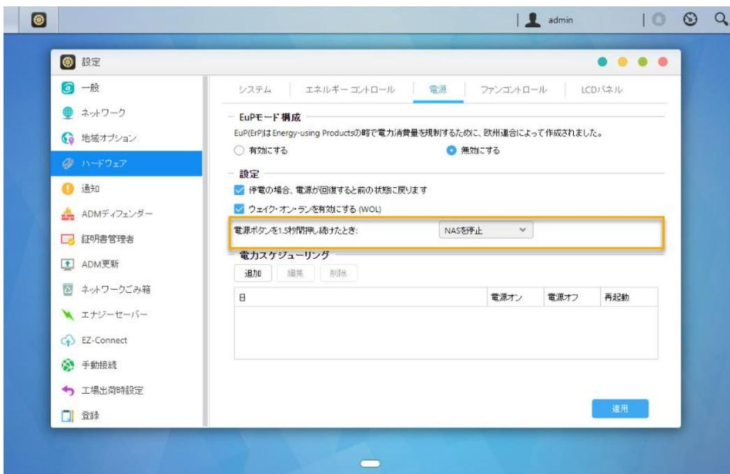
2. 電源ボタンを 1.5 秒間押したままにします。システムブザーから「ビープ音」が聞こえるので、それと同時に電源ボタンを離してください。設定に応じて、NAS はシャットダウンまたはスリープモードに入ります。
