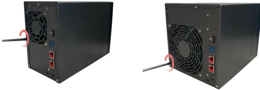
4. ファンのねじを取り外したアナにブラケットを配置します。ファンのねじを再び取り付け、ブラケットを固定します。
