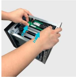
7. 先ほど取り外した SSD キャリアボード固定ネジを締め付けて、SSD キャリアボードを固定します。
