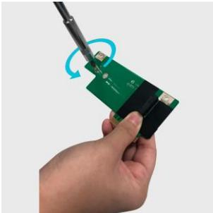
5. SSD をスロットに斜めに挿し込みます。SSD を倒して、先ほど取り外した M.2 固定ネジを SSD キャリアボードに締めます。上記の手順を繰り返して、2 台目の M.2 SSD を取り付けます。
