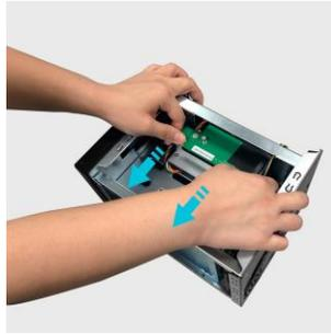
3. 1 台の SSD のみを取り付ける場合には、その SSD を SSD キャリアボードの裏面にあるスロット①に取り付ける必要があります。スロット②は SSD キャリアボードを取り付け時の上面になります。
