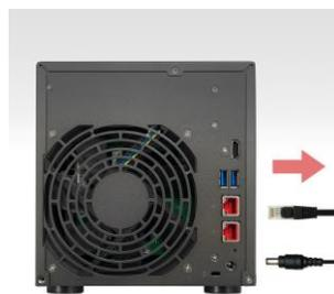
3. 図に示されるように、NAS の背面にある 3 つのねじをドライバーで緩めます。
