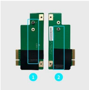
4. SSD キャリアボードに付いている M.2 固定ネジを取り外します。
